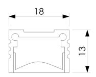
Linearleuchte PICTOR MINI HALBTRANSPARENT 15°, farblos eloxiertes Aluminiumprofil, Abdeckung Linearlinse halbtransparent 15° klickbar, Montage mit Montageklammer, Konverter extern
