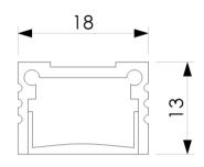
Linearleuchte PICTOR MINI HALBTRANSPARENT 60°, farblos eloxiertes Aluminiumprofil, Abdeckung Linearlinse halbtransparent 60° klickbar, Montage mit Montageklammer, Konverter extern
