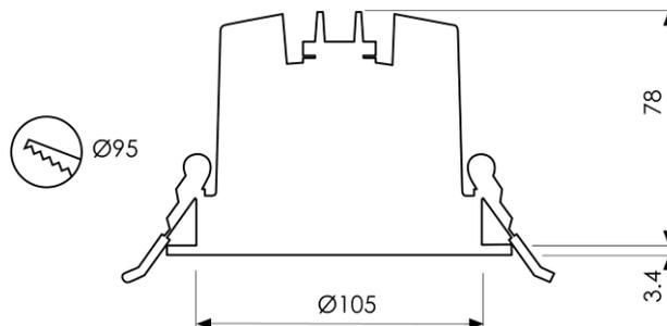
Downlight ARONA DL R105, Aluminiumdruckguss-Gehäuse weiss oder schwarz mit Reflektor silber matt/chrom/schwarz, Einbau mit Clip-Befestigung, LED werkzeuglos tauschbar, Konverter extern (steckbar)
