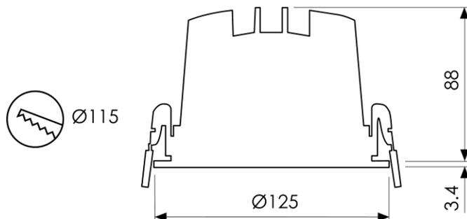
Downlight ARONA DL R125, Aluminiumdruckguss-Gehäuse weiss oder schwarz mit Reflektor silber matt/chrom/schwarz, Einbau mit Clip-Befestigung, LED werkzeuglos tauschbar, Konverter extern (steckbar)
