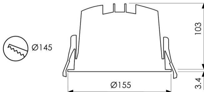
Downlight ARONA DL R155, Aluminiumdruckguss-Gehäuse weiss mit Reflektor silber matt/chrom/schwarz, Einbau mit Clip-Befestigung, LED werkzeuglos tauschbar, Konverter extern (steckbar)
