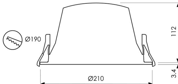
Downlight ARONA DL R210, Aluminiumdruckguss-Gehäuse weiss mit Reflektor silber matt/chrom/schwarz, Einbau mit Clip-Befestigung, LED werkzeuglos tauschbar, Konverter extern (steckbar)
