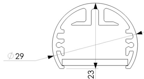
Linearleuchte CIRCUM MIKROPRISMA, farblos eloxiertes Aluminiumprofil, Abdeckung mikroprismatisch klickbar, Montage mit Montageklammer oder Pendelaufhängung, Konverter extern
