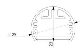
Linearleuchte CIRCUM OPAL, farblos eloxiertes Aluminiumprofil, Abdeckung opal klickbar, Montage mit Montageklammer oder Pendelaufhängung, Konverter extern
