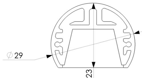
Linearleuchte CIRCUM RASTER BLACK mit Raster und Linse klickbar, schwarz eloxiertes Aluminiumprofil, Montage mit Montageklammer oder Pendelaufhängung, Konverter extern
