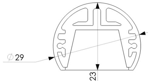
Linearleuchte CIRCUM RASTER METALLIC mit Raster und Linse klickbar, farblos eloxiertes Aluminiumprofil, Montage mit Montageklammer oder Pendelaufhängung, Konverter extern
