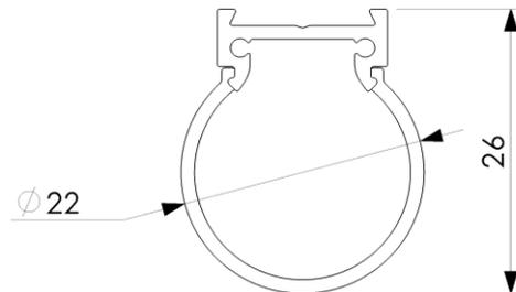
Linearleuchte DIWO, farblos eloxiertes Aluminiumprofil, Abdeckung opal ballon klickbar, Montage mit Montageklammer oder Schraube, Konverter extern
