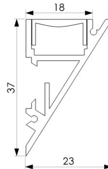
Linearleuchte DRACO HALBTRANSPARENT 30°, farblos eloxiertes Aluminiumprofil, Abdeckung Linearlinse halbtransparent 30° klickbar, Montage mit Montageklammer, Konverter extern
