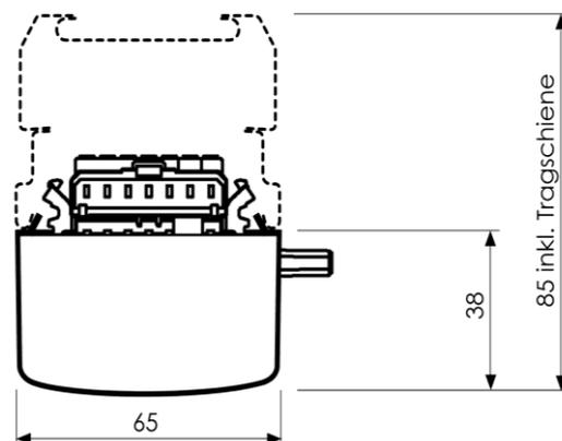
EM Umrüstsatz 1223mm 120°, flexibel + werkzeuglos positionierbar auf EM TRAGSCHIENE, weiss lackiertes Stahlblech, Abdeckung opal, elektrisch steckbar, optional mit Litzen und Schneidekontaktclips für bestehende Durchgangsverdrahtung 1.5mm<sup>2</sup> oder 2.5mm<sup>2</sup>, Leistungsstufen wählbar per DIPSWITCH, Phasen (L1, L2, L3) frei wählbar
