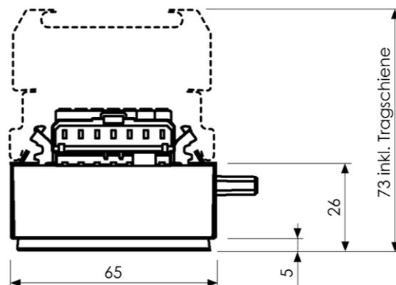
EM Umrüstsatz 1223mm 60°, flexibel + werkzeuglos positionierbar auf EM TRAGSCHIENE, weiss lackiertes Stahlblech, Abdeckung Linse, elektrisch steckbar, optional mit Litzen und Schneidekontaktclips für bestehende Durchgangsverdrahtung 1.5mm<sup>2</sup> oder 2.5mm<sup>2</sup>, Leistungsstufen wählbar per DIPSWITCH, Phasen (L1, L2, L3) frei wählbar
