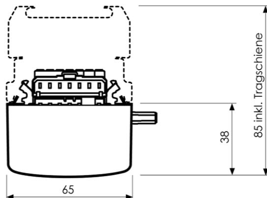
EM Umrüstsatz 1528mm 120°, flexibel + werkzeuglos positionierbar auf EM TRAGSCHIENE, weiss lackiertes Stahlblech, Abdeckung opal, elektrisch steckbar, optional mit Litzen und Schneidekontaktclips für bestehende Durchgangsverdrahtung 1.5mm<sup>2</sup> oder 2.5mm<sup>2</sup>, Leistungsstufen wählbar per DIPSWITCH, Phasen (L1, L2, L3) frei wählbar
