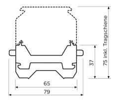
FAST LINE LED LEISTE 1405 90°, flexibel und werkzeuglos positionierbar auf FAST LINE TRAGSCHIENE, weiss lackiertes Stahlblech, Abdeckung Linsenoptik, durchgängig integrierte 13-Polige Verkabelung, Konverter intern, optional mit Notlicht-Element 3h Selbstest
