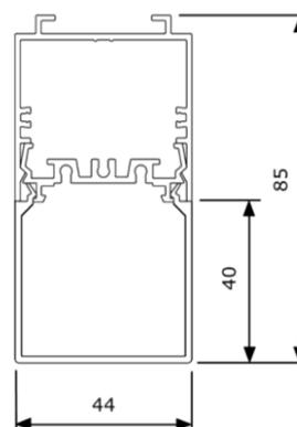
Einzelleuchte FILIGRAN HOCH 600, farblos eloxiertes Aluminiumprofil, Abdeckung opal hoch klickbar, Netzanschlussklemme, Montage Anbau mit Schrauben (bauseitig), Konverter intern
