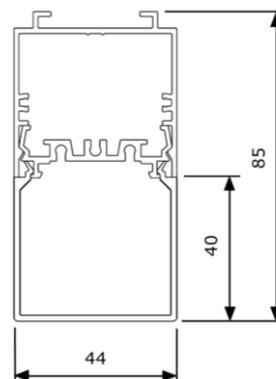
Einzelleuchte FILIGRAN HOCH 900, farblos eloxiertes Aluminiumprofil, Abdeckung opal hoch klickbar, Netzanschlussklemme, Montage Anbau mit Schrauben (bauseitig), Konverter intern
