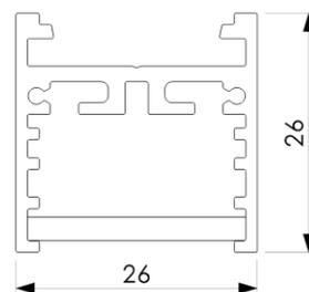
Linearleuchte INDUS MIKROPRISMA, farblos eloxiertes Aluminiumprofil, Abdeckung mikroprismatisch klickbar, Montage mit Montageklammer oder Pendelaufhängung, Konverter extern
