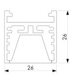
Linearleuchte INDUS RASTER BLACK mit Raster und Linse klickbar, schwarz eloxiertes Aluminiumprofil, Montage mit Montageklammer oder Pendelaufhängung, Konverter extern
