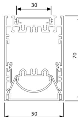
Linearleuchte LINO NANOPRISMA mit INDIREKTLICHT, farblos eloxiertes Aluminiumprofil, Abdeckung nanoprismatisch klickbar, Durchgangsverdrahtung 5-Pol., Netzanschlussklemme, Montage Pendel mit Drahtseilaufhängung, Konverter intern
