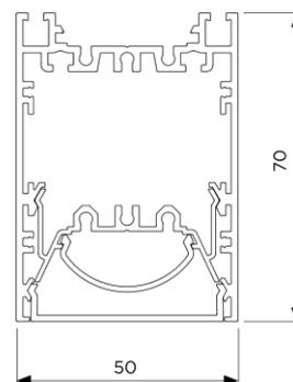
Einzelleuchte LINO NANOPRISMA 1500, farblos eloxiertes Aluminiumprofil, Abdeckung nanoprismatisch
