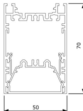
Linearleuchte LINO OPAL, farblos eloxiertes Aluminiumprofil, Abdeckung opal klickbar, Durchgangsverdrahtung 5-Pol., Netzanschlussklemme, Montage Pendel mit Drahtseilaufhängung oder Anbau mit Schrauben (bauseitig), Konverter intern
