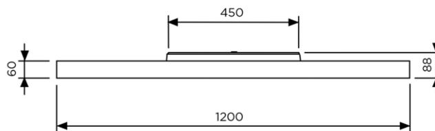
Anbau- und Pendelleuchte LUCCA 1200 OPAL + INDIREKT, weisses oder schwarzes Aluminiumgehäuse, Abdeckung opal, Netzanschlussklemme, Montage Pendel mit Drahtseilaufhängung oder Pendelstange oder Anbau mit Schrauben (bauseitig), Konverter intern
