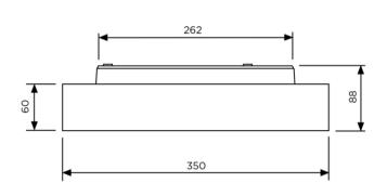
Anbau- und Pendelleuchte LUCCA 350 MIKROPRISMA + INDIREKT, weisses oder schwarzes Aluminiumgehäuse, Abdeckung mikroprismatisch, Netzanschlussklemme, Montage Pendel mit Drahtseilaufhängung oder Pendelstange oder Anbau mit Schrauben (bauseitig), Konverter intern
