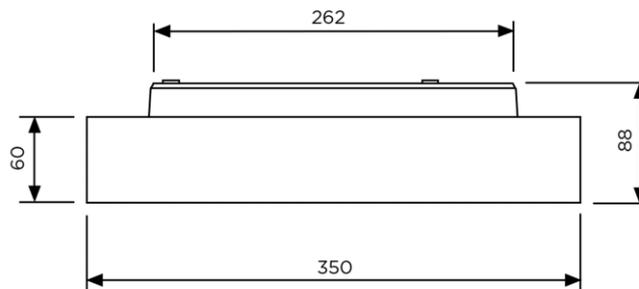
Anbau- und Pendelleuchte LUCCA 350 OPAL + INDIREKT, weisses oder schwarzes Aluminiumgehäuse, Abdeckung opal, Netzanschlussklemme, Montage Pendel mit Drahtseilabhängung oder Pendelstange oder Anbau mit Schrauben (bauseitig), Konverter intern
