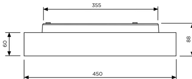
Anbau- und Pendelleuchte LUCCA 450 OPAL + INDIREKT, weisses oder schwarzes Aluminiumgehäuse, Abdeckung opal, Netzanschlussklemme, Montage Pendel mit Drahtseilaufhängung oder Pendelstange oder Anbau mit Schrauben (bauseitig), Konverter intern
