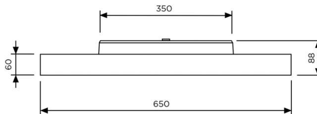
Anbau- und Pendelleuchte LUCCA 650 OPAL + INDIREKT, weisses oder schwarzes Aluminiumgehäuse, Abdeckung opal, Netzanschlussklemme, Montage Pendel mit Drahtseilaufhängung oder Pendelstange oder Anbau mit Schrauben (bauseitig), Konverter intern
