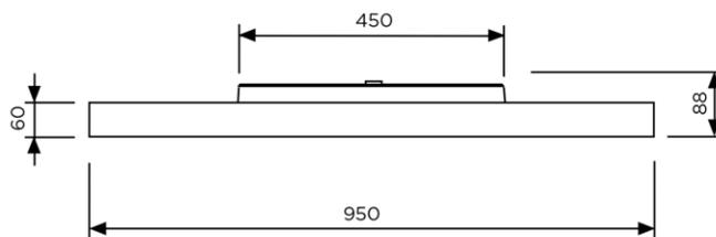
Anbau- und Pendelleuchte LUCCA 950 OPAL + INDIREKT, weisses oder schwarzes Aluminiumgehäuse, Abdeckung opal, Netzanschlussklemme, Montage Pendel mit Drahtseilaufhängung oder Pendelstange oder Anbau mit Schrauben (bauseitig), Konverter intern
