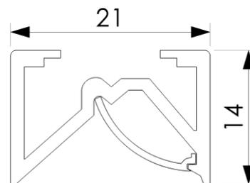
Linearleuchte LYRO, farblos eloxiertes Aluminiumprofil, Abdeckung opal klickbar, Montage mit Montageklammer, Konverter extern
