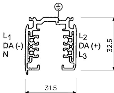
NORDIC GLOBAL TRAC PULSE STROMSCHIENE, kombinierbar mit handelsüblichen Stromschienenstrahler, weiss/grau/schwarz lackiertes Stahlblech, durchgängig integrierte Verdrahtung, Montage Pendel mit Drahtseilaufhängung oder Anbau mit Klammer
