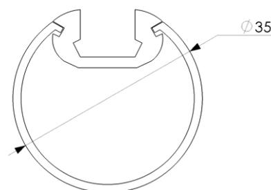
Linearleuchte ORION, farblos eloxiertes Aluminiumprofil, Abdeckung opal ballon klickbar, Montage mit Montageklammer, Konverter extern
