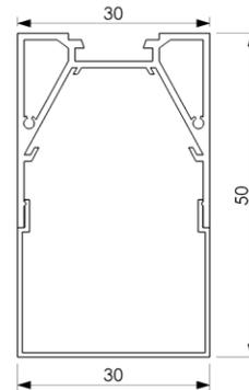
Linearleuchte PAVO MINI HOCH, farblos eloxiertes Aluminiumprofil, Abdeckung opal hoch klickbar, Montage mit Montageklammer, Konverter extern
