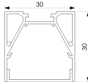
Linearleuchte PAVO MINI MIKROPRISMA, farblos eloxiertes Aluminiumprofil, Abdeckung Mikroprisma klickbar, Montage mit Montageklammern, Konverter extern
