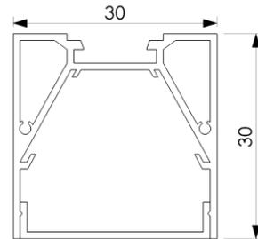
Linearleuchte PAVO MINI OPAL, farblos eloxiertes Aluminiumprofil, Abdeckung opal klickbar, Montage mit Montageklammer, Konverter extern
