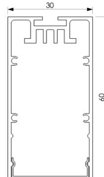
Linearleuchte PAVO OPAL, farblos eloxiertes Aluminiumprofil, Abdeckung opal clickbar, Durchgangsverdrahtung 5-Pol., Netzanschlussklemme, Montage Wand mit Wandwinkelhalter oder Montage Anbau mit Schrauben (bauseitig), Konverter intern
