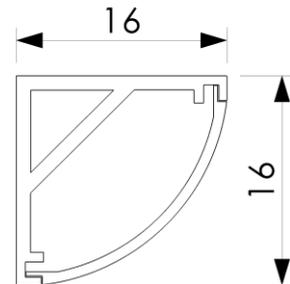
Linearleuchte PEGASUS MINI HALBRUND, farblos eloxiertes Aluminiumprofil, Abdeckung opal halbrund klickbar, Montage mit Montageklammer, Konverter extern
