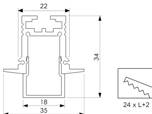
Linearleuchte PICTOR EINBAU HOCH, farblos eloxiertes Aluminiumprofil, Abdeckung opal hoch klickbar, Montage mit Montageklammer, Konverter extern
