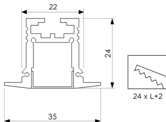
Linearleuchte PICTOR EINBAU OPAL, farblos eloxiertes Aluminiumprofil, Abdeckung opal klickbar, Montage mit Montageklammer, Konverter extern
