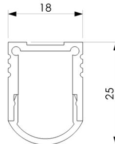
Linearleuchte PICTOR HALBRUND, farblos eloxiertes Aluminiumprofil, Abdeckung opal halbrund klickbar, Montage mit Montageklammer, Konverter extern
