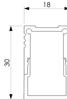
Linearleuchte PICTOR HOCH, farblos eloxiertes Aluminiumprofil, Abdeckung opal hoch klickbar, Montage mit Montageklammer, Konverter extern
