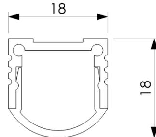
Linearleuchte PICTOR MINI HALBRUND, farblos eloxiertes Aluminiumprofil, Abdeckung opal halbrund klickbar, Montage mit Montageklammer, Konverter extern
