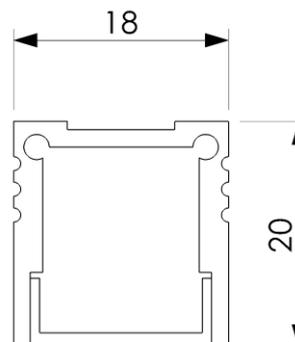
Linearleuchte PICTOR OPAL, farblos eloxiertes Aluminiumprofil, Abdeckung opal klickbar, Montage mit Montageklammer, Konverter extern
