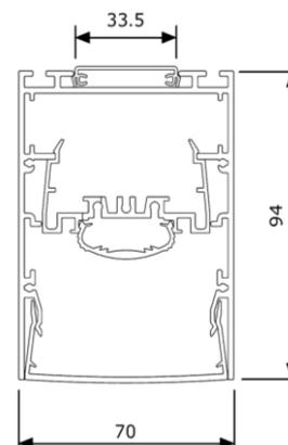
Linearleuchte SINTA MIKROPRISMA mit INDIREKTLICHT, farblos eloxiertes Aluminiumprofil, Abdeckung mikroprismatisch klickbar, Durchgangsverdrahtung 5-Pol., Netzanschlussklemme, Montage Pendel mit Drahtseilaufhängung, Konverter intern
