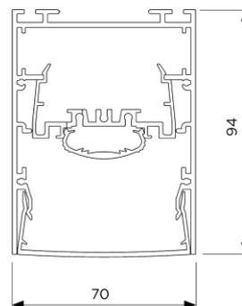
Linearleuchte SINTA MIKROPRISMA, farblos eloxiertes Aluminiumprofil, Abdeckung mikroprismatisch klickbar, Durchgangsverdrahtung 5-Pol., Netzanschlussklemme, Montage Pendel mit Drahtseilaufhängung oder Anbau mit Schrauben (bauseitig), Konverter intern
