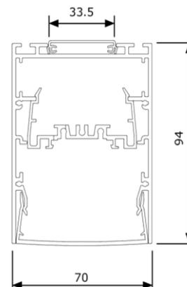
Linearleuchte SINTA OPAL mit INDIREKTLICHT, farblos eloxiertes Aluminiumprofil, Abdeckung opal clickbar, Durchgangsverdrahtung 5-Pol., Netzanschlussklemme, Montage Pendel mit Drahtseilaufhängung, Konverter intern
