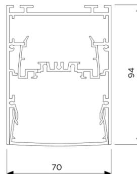
Linearleuchte SINTA OPAL, farblos eloxiertes Aluminiumprofil, Abdeckung opal klickbar, Durchgangsverdrahtung 5-Pol., Netzanschlussklemme, Montage Pendel mit Drahtseilaufhängung oder Anbau mit Schrauben (bauseitig), Konverter intern
