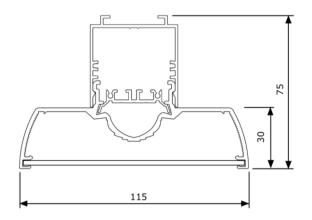
Linearleuchte TIRO, farblos eloxiertes Aluminiumprofil, Abdeckung opal klickbar, Durchgangsverdrahtung 5-Pol. Netzanschlussklemme, Montage Pendel mit Drahtseilaufhängung oder Anbau mit Schrauben (bauseitig), Konverter intern
