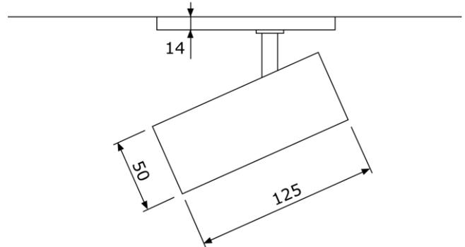
InTrack Stromschienenstrahler TOPA 50 mit Linsen Optik, Aluminiumdruckguss-Gehäuse schwarz oder weiss, Konverter extern
