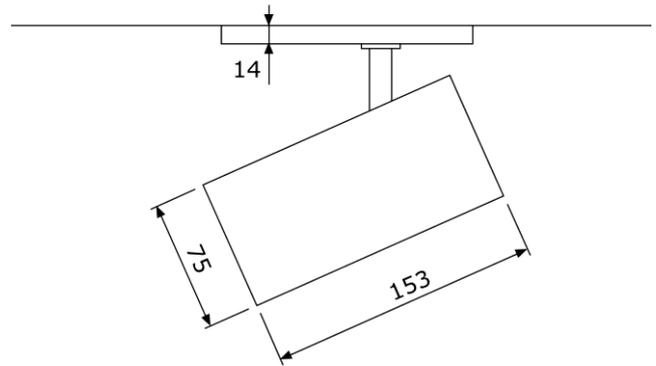
InTrack Stromschienenstrahler TOPA75 mit Linsen Optik, Aluminiumdruckguss-Gehäuse schwarz oder weiss, Konverter extern
